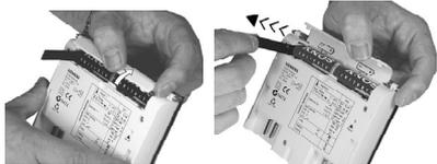
1. Sortir l'appareil du socle et ouvrir le couvercle rabattable du compartiment piles.
