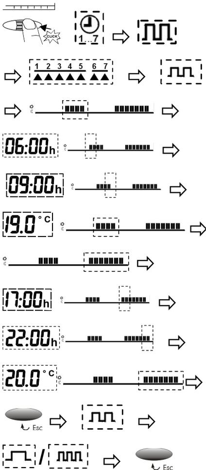
Si aucune touche n'est actionnée dans un délai de 10 s, le réglage affiché est accepté et on revient à l'affichage initial.
