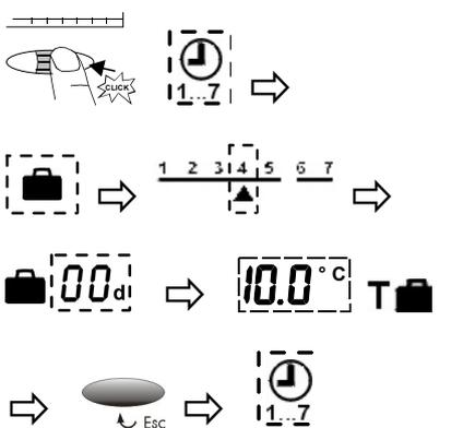
Si aucune touche n'est actionnée dans un délai de 10 s, le réglage affiché est accepté et on revient à l'affichage initial.
